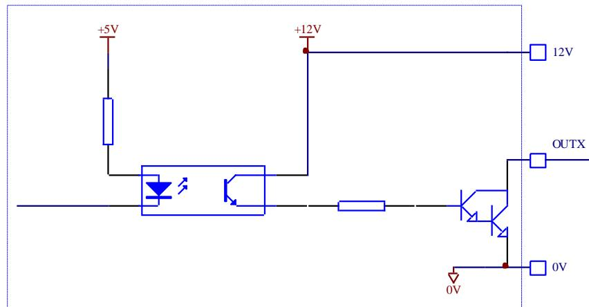
开关量输出一般外接中间继电器，仪表提供一组辅助 DC12V 电源输出，可以直接用来驱动外部继电器。实际电路如下：
